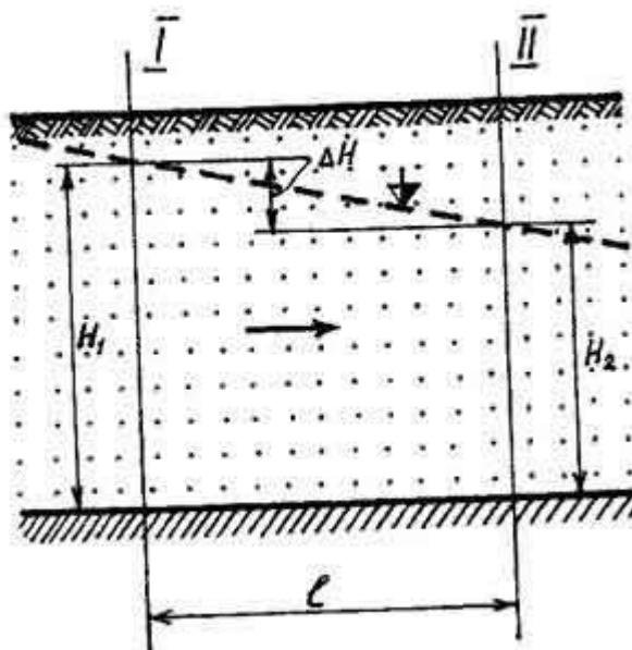
Рисунок 5.2 — Схема руху ґрунтової води
