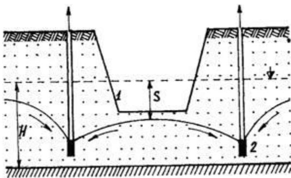
Рисунок 5.16 — Осушення будівельного котловану голкофільтрами: 1 – будівельний котлован; 2 – голкофільтри
