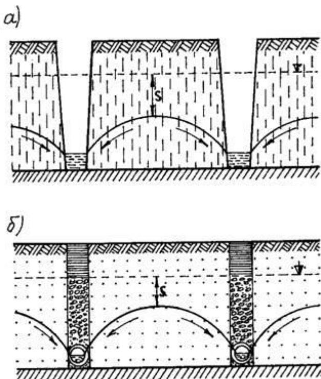
Рисунок 5.15 — Дренажні траншеї: а – відкриті; б – закриті
