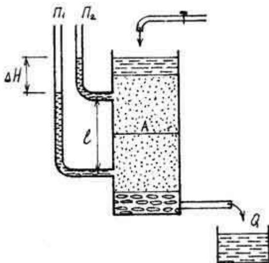
Рисунок 5.9 — Схема приладу для визначення коефіцієнта фільтрації пісків
