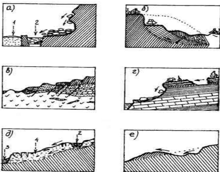
Рисунок 8.3 — Основні форми порушення стійкості і деформації схилів: а — обвали, вивали; б — обрушенння із зрізом та обертанням; в — скол при просіданні; г — сковзання; д — покривні зсуви (сповзання); е — обплівання; 1 — шлях; 2 — канал; 3 — річка; 4 — зсувний делювій
