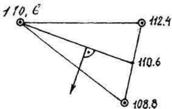
Рисунок 5.10 — Схема визначення напрямку руху ґрунтових вод
