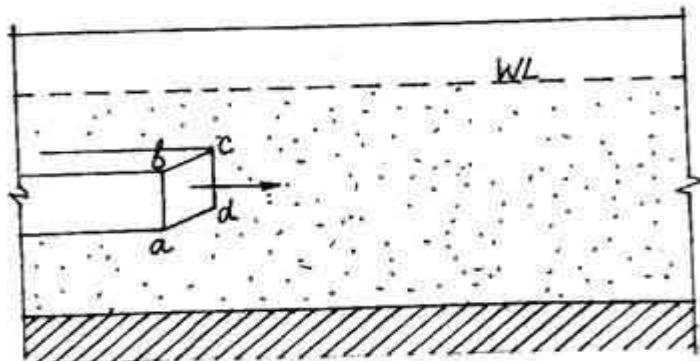
Рисунок 5.1 — Схема визначення дебіту водоносного горизонту
