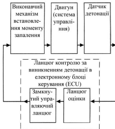
Рис. 3.9. Схема дії системи захисту двигуна від детонації
