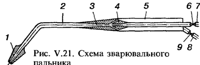
Рис.3.2. Схема зварювального пальника
