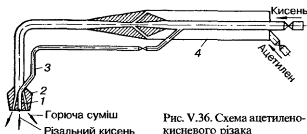
Рис. 3.3. Схема ацетиленокисневого різакі
