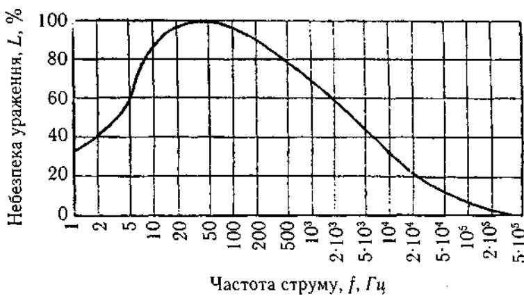
Рис. 7.2. Залежність небезпеки ураження струмом від його частоти
