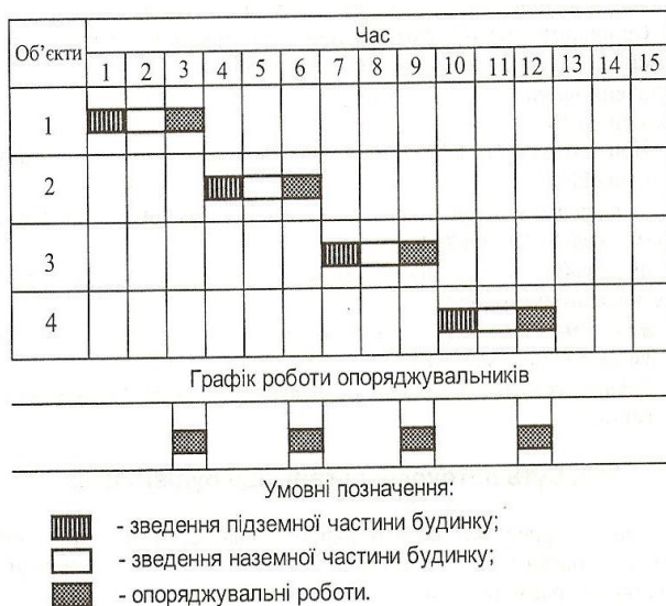
Рис.2. Паралельний метод будівництва Рис.3. Послідовний метод будівництва
