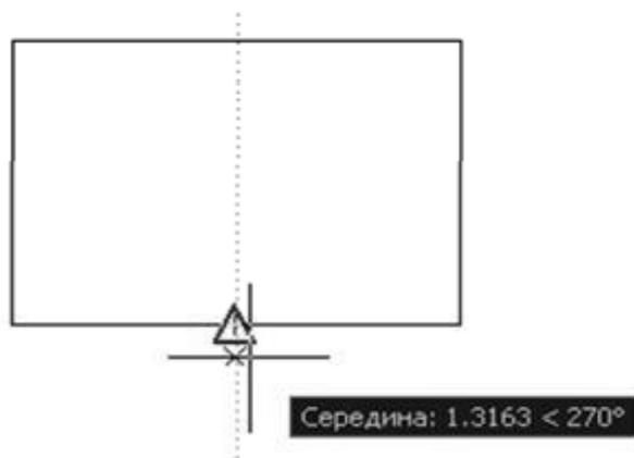
Рис. 5.4. Демонстрація режиму “ПРИВЯЗКА”
