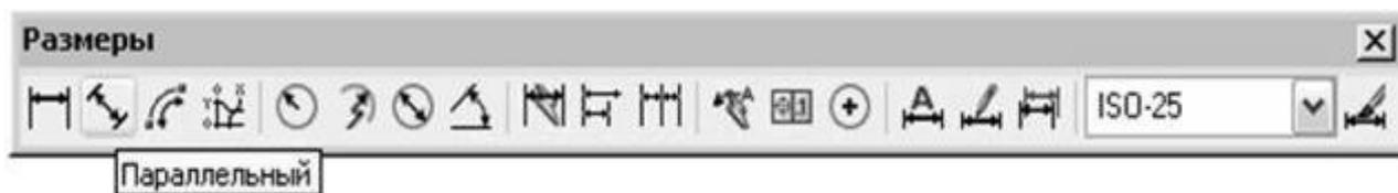
Рис. 9.3. Команда „Параллельный” на панели инструментов „Размеры”
