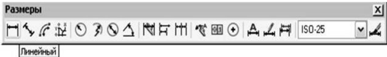
Рис. 9.2. Команда „Линейный” на панели инструментов „Размеры”
