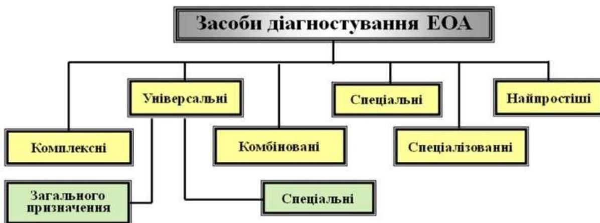
**Рисунок 6.6 - Класифікація засобів діагностики електричних пристрій та систем за функціональним наповненням**
