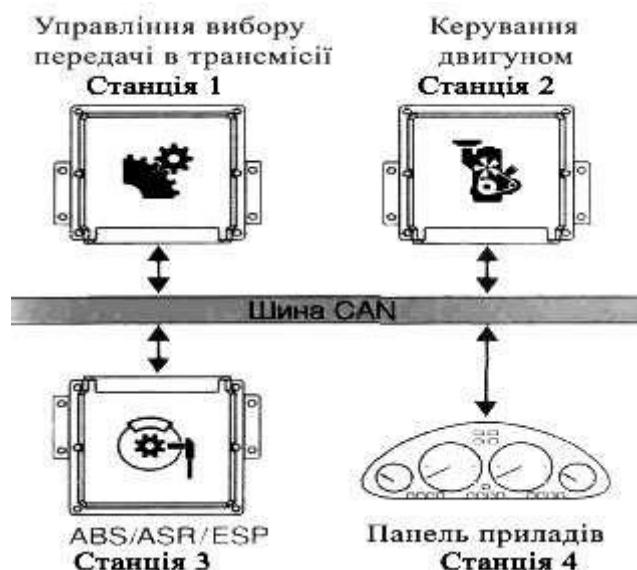
**Рисунок 2.2 - Лінійна структура шини CAN**
