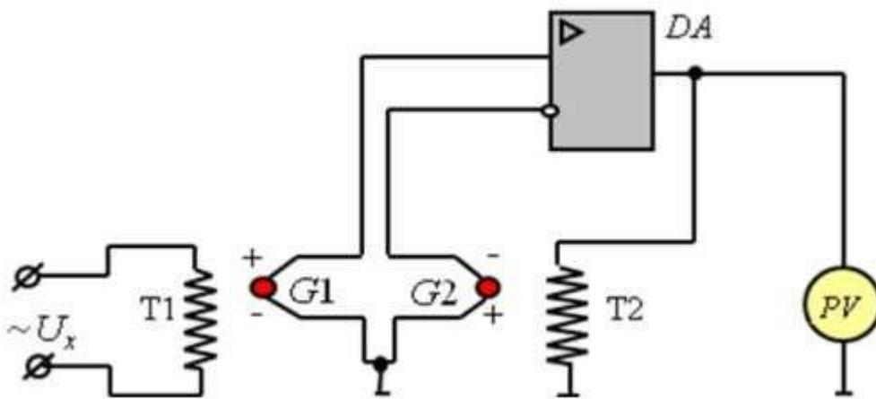
**Рисунок 7.3 - Принципова схема детектора середньоквадратичних значень з термоперетворювачами**
