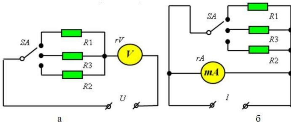
Рисунок 7.7 - Схеми багатограницичних вимірювальних приладів:
