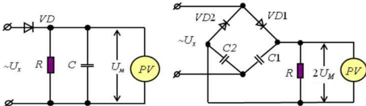
**Рисунок 7.5 - Принципові схеми пікових вольтметрів:**
