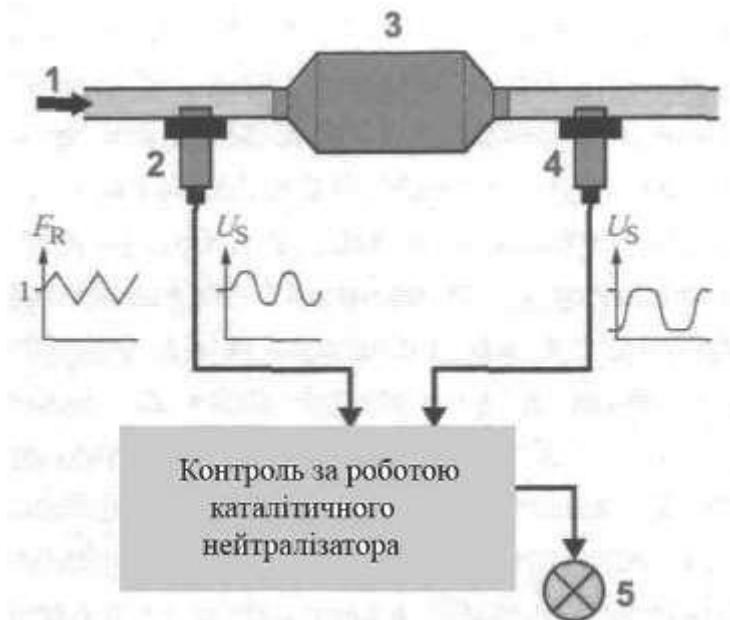
**Рисунок 5.1 - Діагностика первинного каталітичного нейтралізатора**
