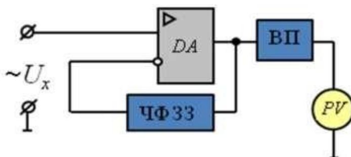
**Рисунок 7.6 - Принципова схема селективного вольтметра**
