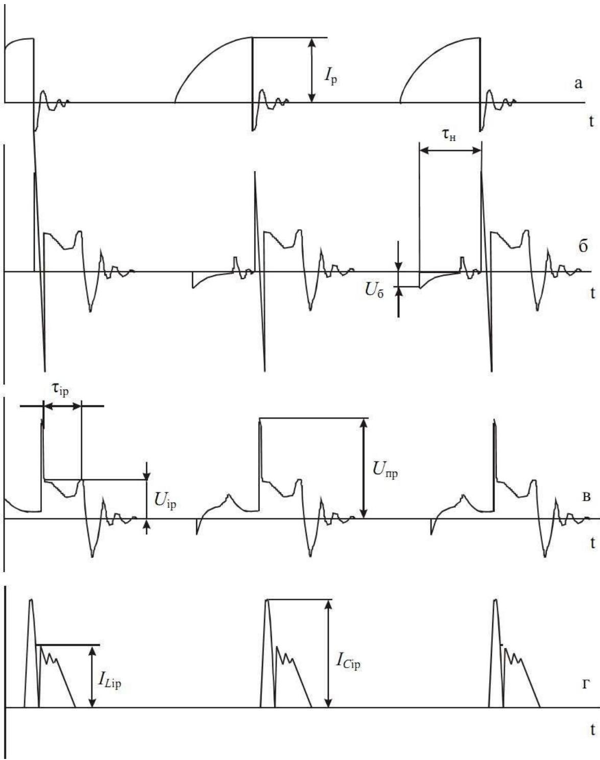
Рисунок 7.16 - Осцилограмми електричних процесів у колах справної системи запалювання: а - струм первинного кола; б - напруга первинного кола; в - напруга вторинного кола; г - струм іскрового розряду
