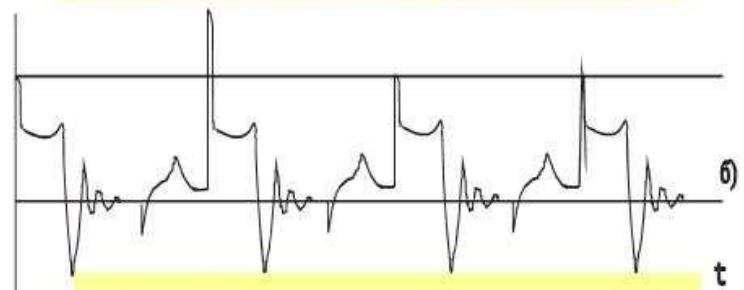
збільшений зазор другої свічки
