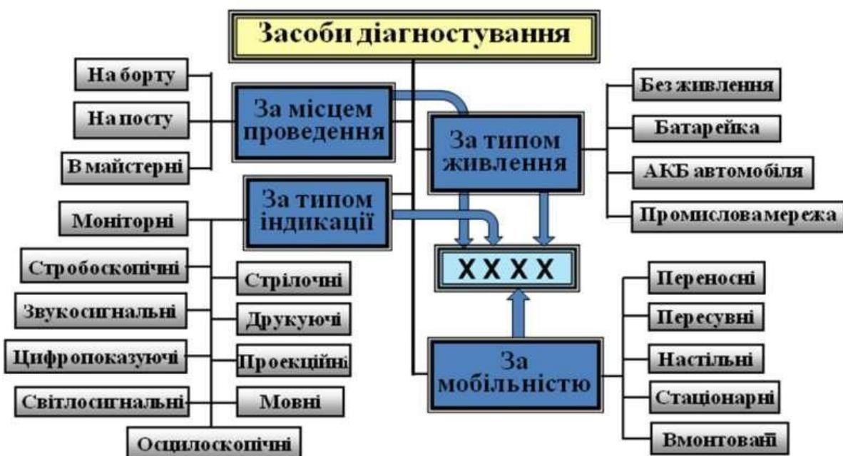
**Рисунок 6.5 - Класифікація засобів діагностики за конструкційними ознаками**
