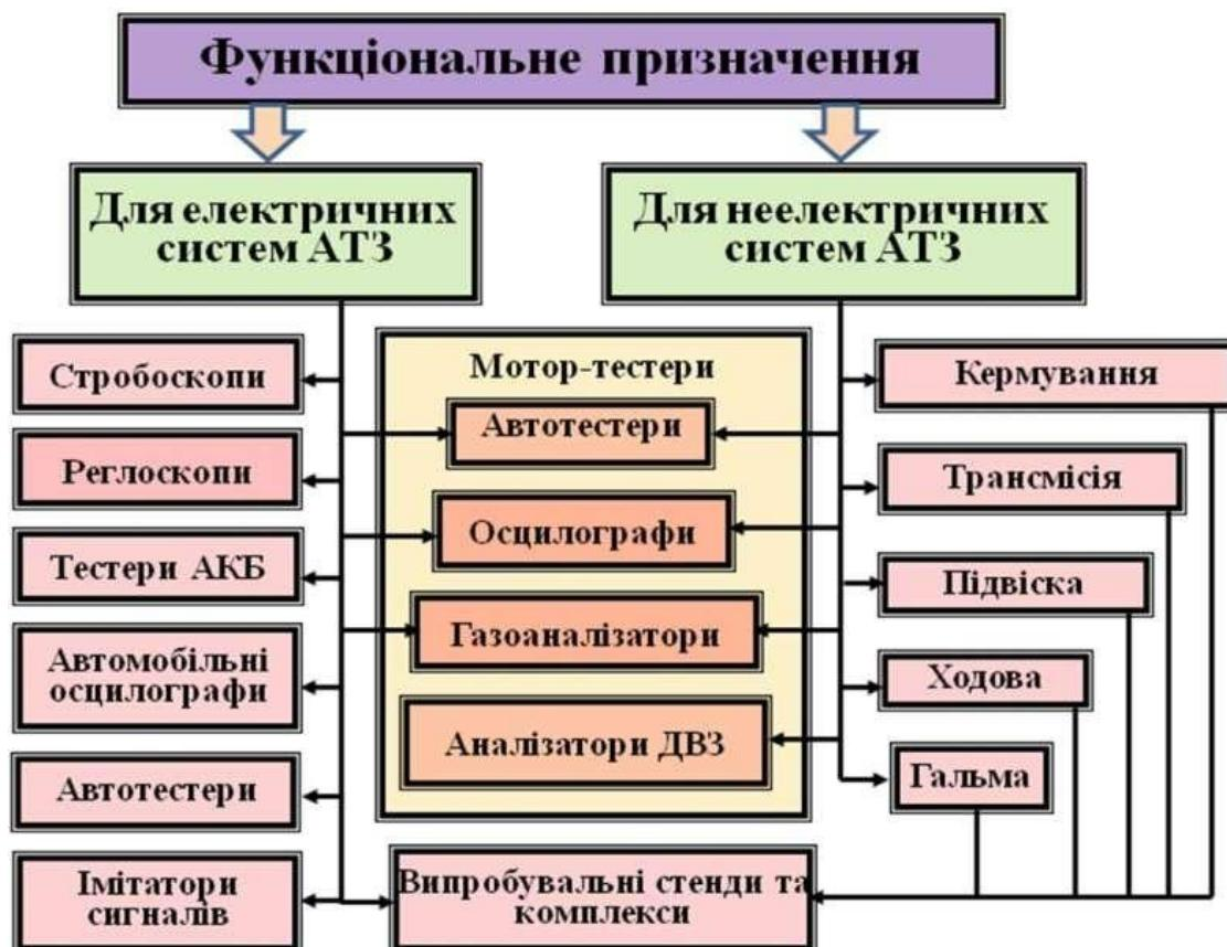
Рисунок 6.3 - Класифікація електрических засобів діагностування АТЗ за призначенням
