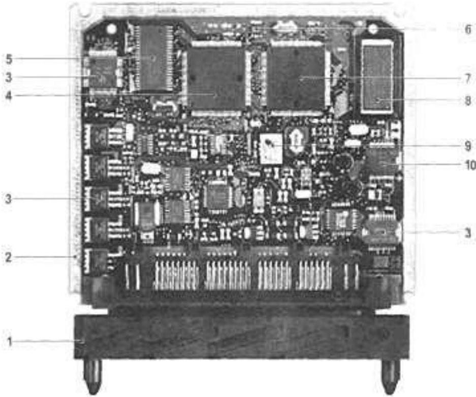
**Рисунок 1.2 - Блок керування системи МЕ-Motronic:**
