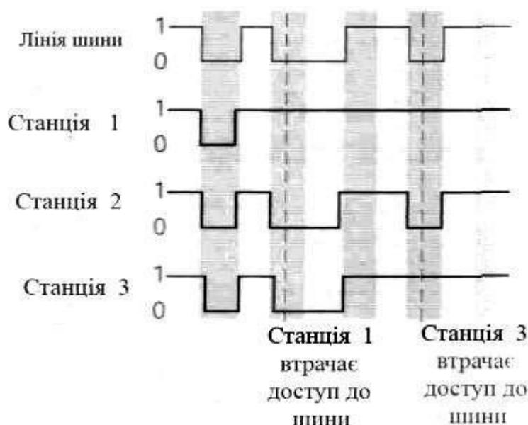
Рисунок 2.3 - Адресація і фільтрація повідомлень по шині CAN:
