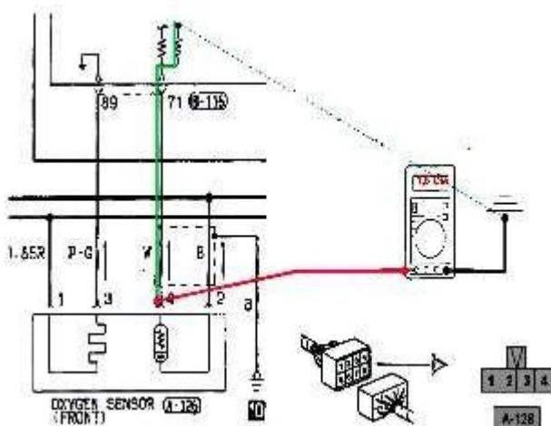
**Рисунок 4.3 - Перевірка опору дротів в джгутах**
