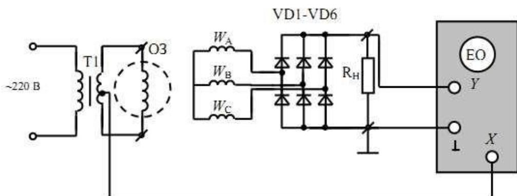
Рисунок 7.21 - Схема вимірювання параметрів генератора безмоторним осцилоскопічним способом
