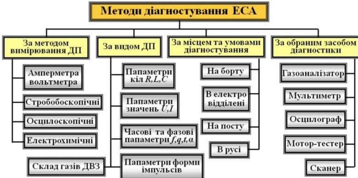
**Рисунок 6.8 - Класифікація методів діагностування електричних систем автомобіля**
