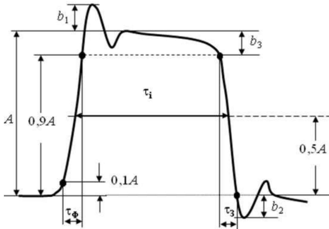
Рисунок 7.9 - Параметри реального імпульсу
