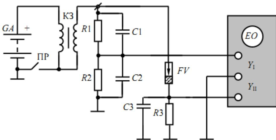
Рисунок 7.17 - Схема виміру параметрів вторинного кола
