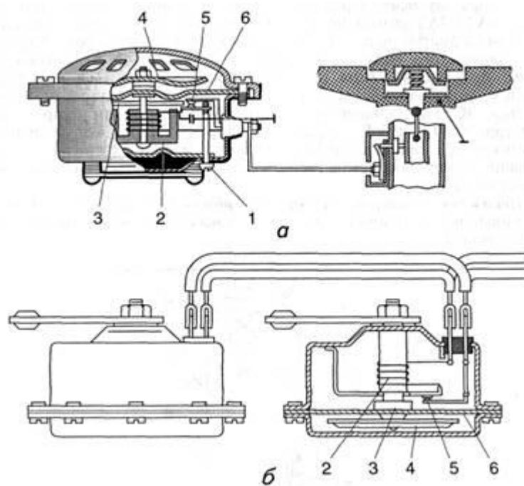
**Рисунок 6.4 - Звуковий сигнал — вібраційного типу без рупорний**
