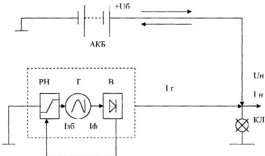
**Рисунок 1.1 - Схема електрична – структурна джерел електропостачання автомобіля**
