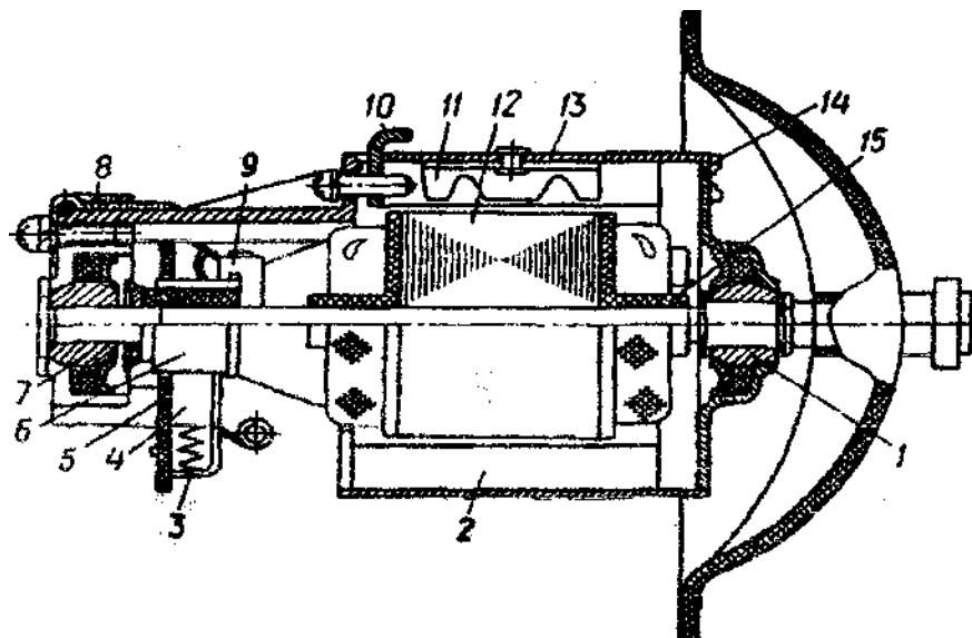
**Рисунок 6.3 - Електродвигун зі збудженням від постійних магнітів:**
