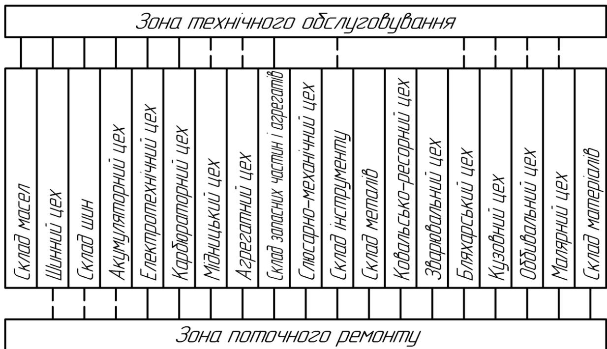
Рисунок 6.2 – Зв'язок виробничих дільниць із основними зонами АТП:
