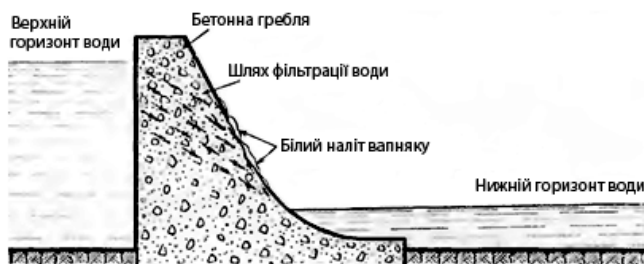
Мал. 10. Розчинення і винесення гідроксиду кальцію з бетону
