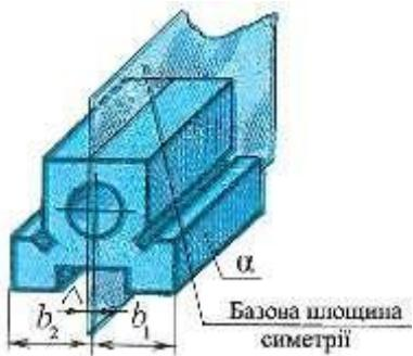
**Рис. 3.14. Відхилення від симетричності:**
