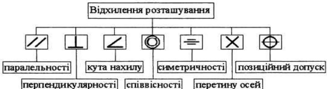
*Рис.3.6. Відхилення розташування поверхонь*
