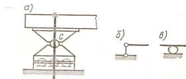
**Шарнірно рухома** опора допускає обертання навколо осі шарніра і поступове переміщення по опорній площині, яка називається опорною подушкою.
