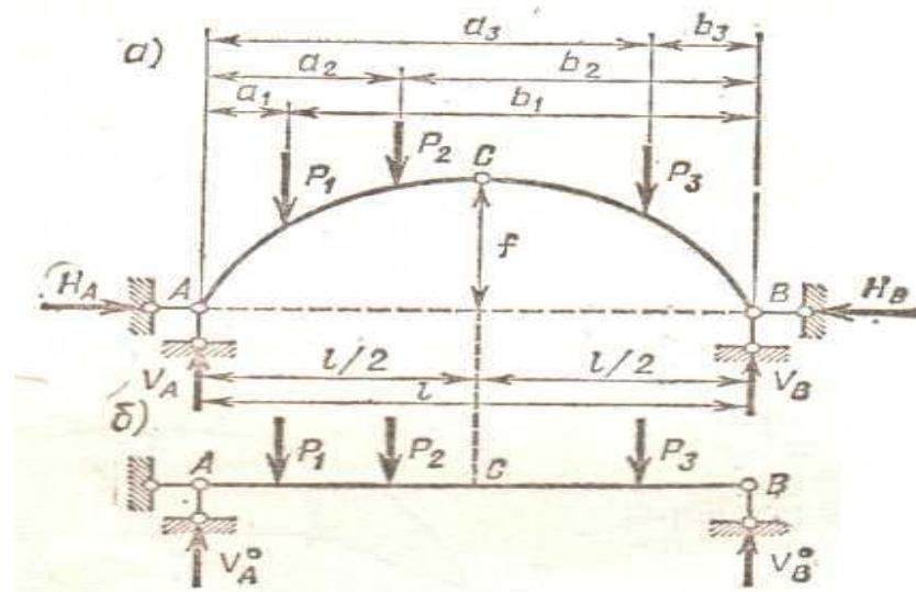
Оскільки, арочна система являється криволінійним елементом, то при визначенні поперечної та поздовжньої сил необхідно враховувати значення кутів дії сил.
