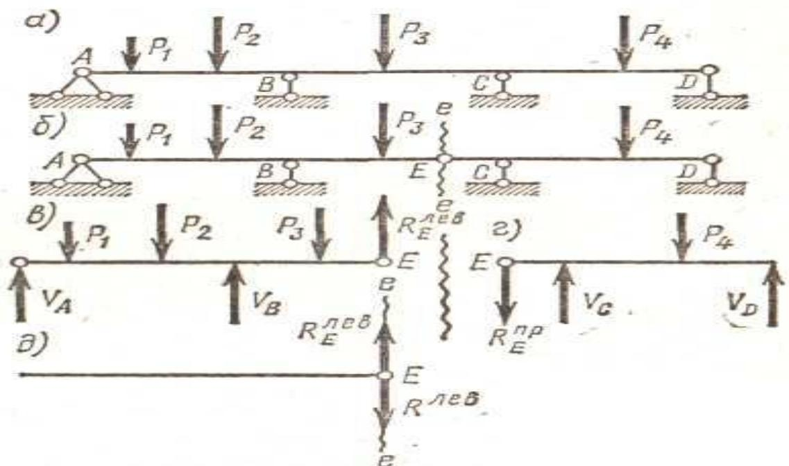
Нехай дана шарнірна балка, у якої число опорних стержнів рівно  $C_{оп}$ , а число проміжних шарнірів  $Ш$ . По визначенням, шарнірна балка являється статично визначеною системою. Тому умови геометричної незмінності та статичної визначеності дорівнюють 0, тобто:
