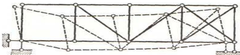
Геометрично змінна тому що в першій панелі має місце шарнірний квадрат (найпростіша змінна система), який навіть при незначному навантаженні перетворюється в ромб і викликає зміщення всіх вузлів ферми вліво.
