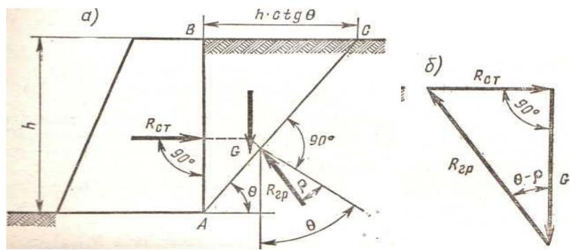
**4) Аналітичне визначення активного тиску (розпору) та пасивного тиску (опору) сипучого тіла на підпірну стіну для випадку вертикальної гладкої стіни і горизонтальної поверхні сипучого тіла.**
