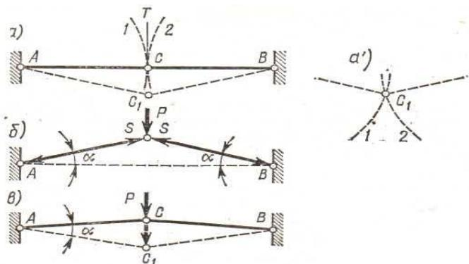
переходять в кінцеві, і дуже значні порівнюючи з переміщеннями звичайних незмінних систем, тому миттєво змінні системи в якості будівельних споруд не застосовуються.
