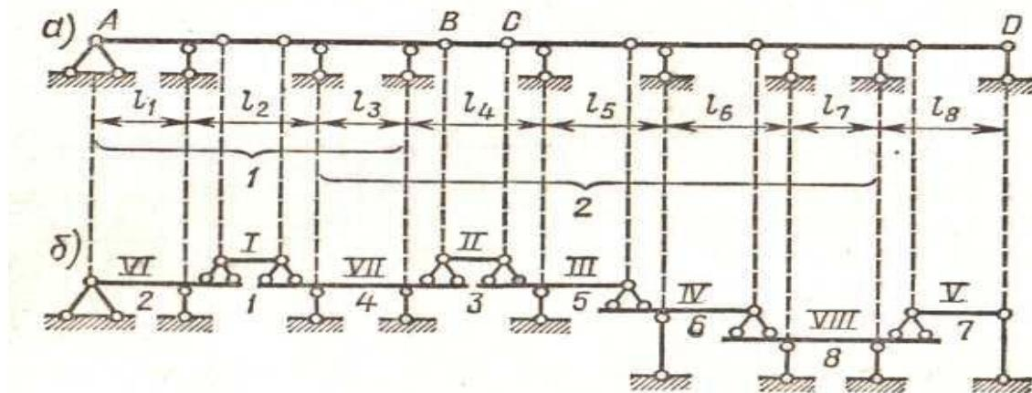
Поділ балок на основні і другорядні дозволяє з'ясувати, як відбувається передача силових зусиль від однієї балки до іншої. Для прикладу багатопрольотну шарнірну балку зображають у вигляді поверхової схеми.
