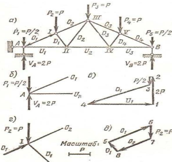
В опорному вузлі А сходяться чотири збалансовані сили – реакція  $V_A = 2P$ , сила  $P_1 = P/2$  (зовнішні зусилля) і внутрішні зусилля в стержнях  $O_1$  і  $U_1$ . Вирізємо цей вузол і будуємо для нього замкнутий багатокутник сил.
