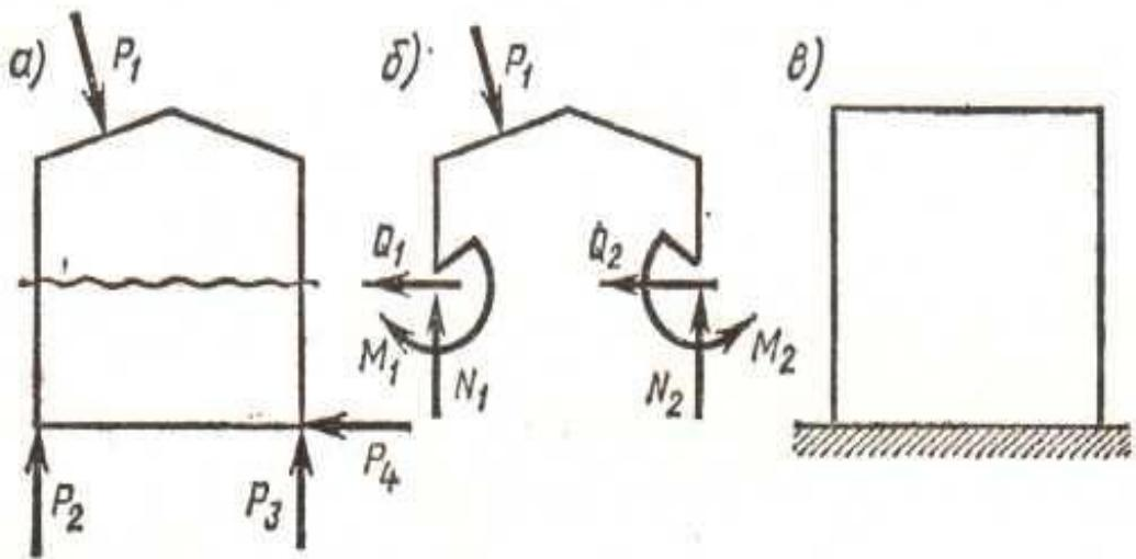
Розглянемо раму, яка складається з стержнів які утворюють один безшарнірний замкнутий контур. Кожний такий контур три рази статично невизначений, тому що коли ми його переріжемо, то до верхньої частини, що залишилась, в місці розрізу кожного елементу потрібно прикласти поперечну силу, згинальний момент, і повздовжню силу, які будуть замінити дію відкинутої частини.
