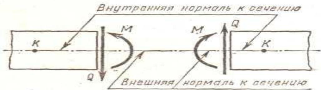
Статичний розрахунок шарнірної балки полягає у визначенні поперечних сил і згинальних моментів та побудові епюор  $Q$  і  $M$ . Згодом по цих епюрах проводять підбір поперечного перерізу або виконують його перевірку.
