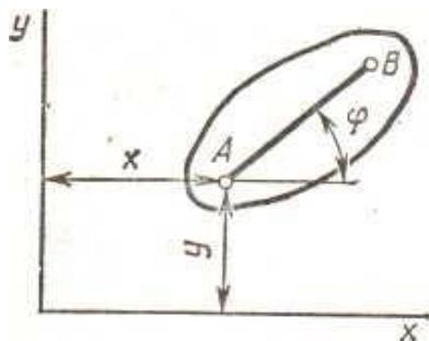
Люба споруда в будівельній практиці повинна представляти собою чи геометрично незмінну систему, нерухомо приєднано до землі, чи так звану зв'язану систему. Тому диски між собою і система в цілому з'єднується з землею зв'язками (стержні з шарнірами, шарніри, жорсткі закріплення).
