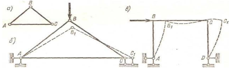
**Геометрично змінною системою називають таку систему, форма якої різко змінюється при зміні положення її в просторі чи при навантаженні навіть дуже малою силою.**
