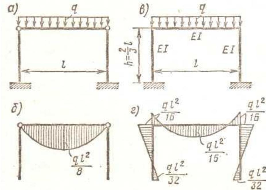
В першій рамі ригель згинається таким чином, що його кінцеві перерізи повертаються вільно і не втягують в згинну деформацію стійки; тому стійки працюють тільки на осьовий стиск.
