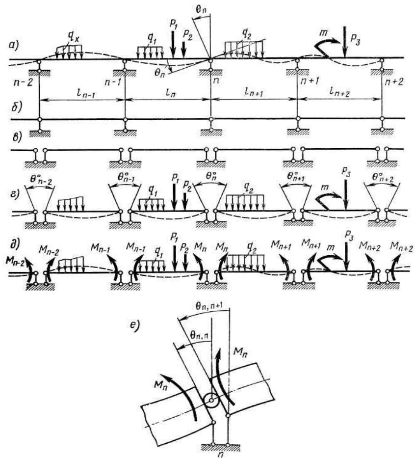
Тоді, внаслідок наявності шарнірних опор, окремі балочки основної системи вигнутуться, а їх опорні перерізи повернуться один відносно другого і утворять так звані кути перелому.
