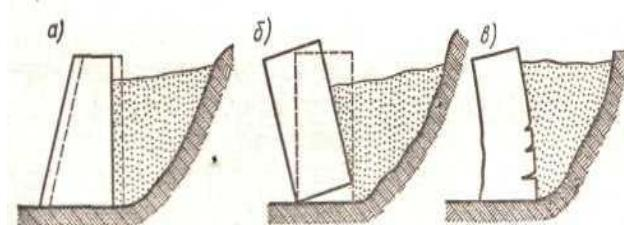
Стійкість масивних стін забезпечується в основному їх власною вагою, напівмасивних -- як власною вагою, так і вагою ґрунту, який лежить на фундаментній плиті, тонко елементних-- в основному за рахунок ваги ґрунту і лише в незначній мірі власної ваги, шпунтових стін досягається защемленням шпунта в ґрунті, а частіше додатково і заанкеруванням.
