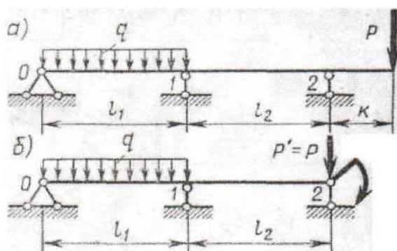
Відкидаємо умовно (подумки) консоль і замінюємо її (консоль) вплив на частину, яка залишилась, силою  $P^1 = P$  і парою сил з моментом  $M_2 = - P K$ , прикладених в опорному перерізі.
