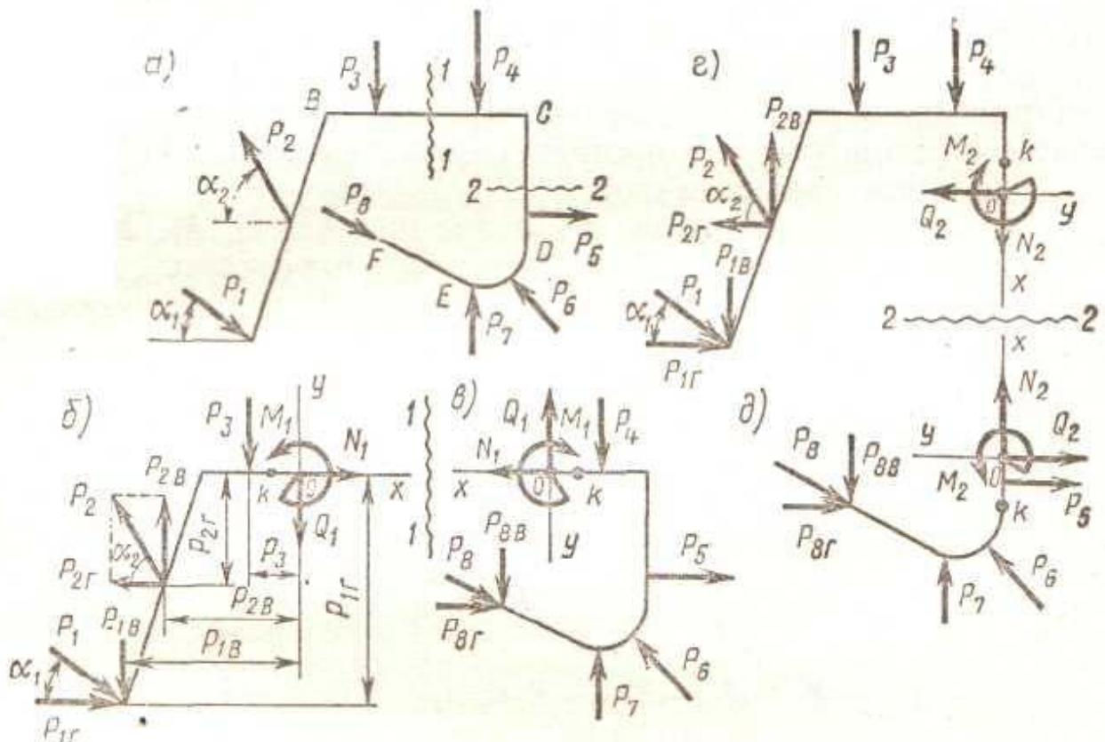
Статичний розрахунок рамних систем полягає у визначенні поперечних сил  $Q$ , згинальних моментів  $M$  та поздовжніх сил  $N$ . Що таке поперечна сила та згинальний момент вказано в темі 3 (шарнірна балка), тому в даній темі дамо визначення тільки поздовжньої сили  $N$ .
