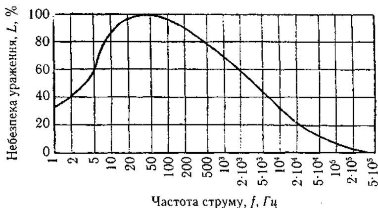
Рис. 7.2. Залежність небезпеки ураження струмом від його частоти
