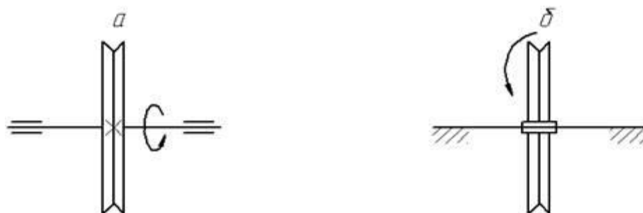
Рис. 9.4. Схеми осей за можливістю обертання
