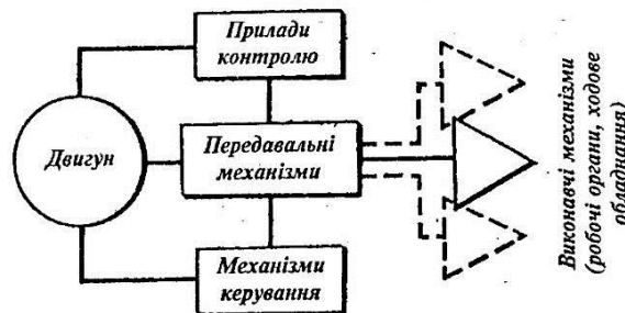
Рис. 2.1. – Структурна схема будівельної машини
