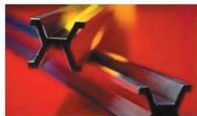
Рис. 2.2. Міжнародний еталон метра, що використовувався в 1899–1960 рр. і зараз зберігається в Палаті мір і ваг у м. Севрі (неподалік Парижа)
