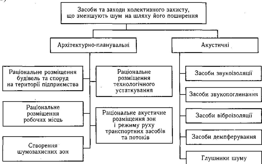
Рис.5.1. Класифікація засобів та заходів колективного захисту, що зменшують шум на шляху його поширення
