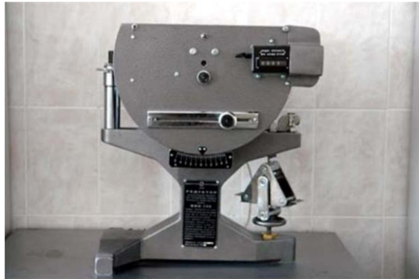
Рисунок 6.6 – Прилад-автомат МП–100 для випробування зразків на вигин
