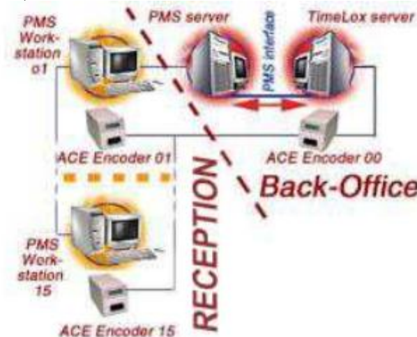
Рис. 8.1 – Автономна система контролю доступу, інтегрована з системою управління
