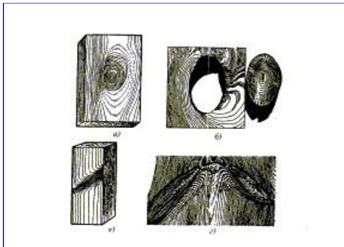
Рис. 2.5.1. Різні види сучків: а – здоровий, б – випадний, в – зшивний, г – розгалужений
