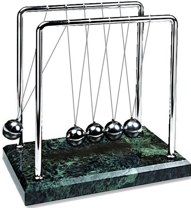
Рис.1. Колиска Ньютона — це пристрій, що демонструє закон збереження імпульсу та енергії
