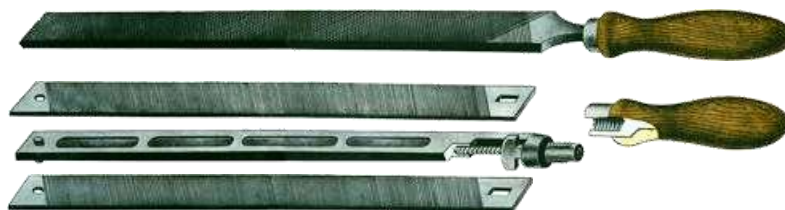
Рис.1.9.Безпечна рукоятка напилків
