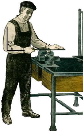
Рис. 1.11. Положення рук, корпуса і ніг при обпилюванні
