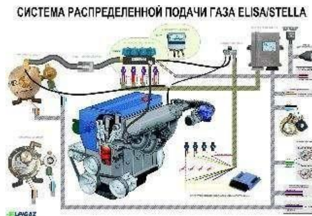
Рис 6.1. Система ГБО 4-го покоління (розподіленого уприскування газу)
