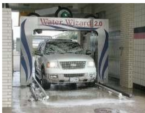
Рис. 3.7. Щіткові мийні установки порталного типу
