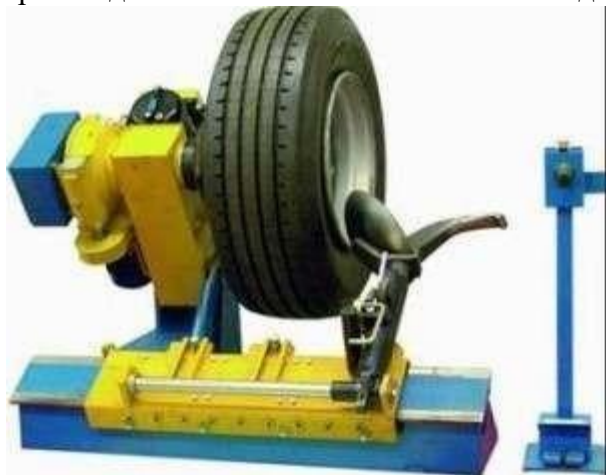
Рис. 5.8. Шиниомонтажний стенд ШМГ-1В
