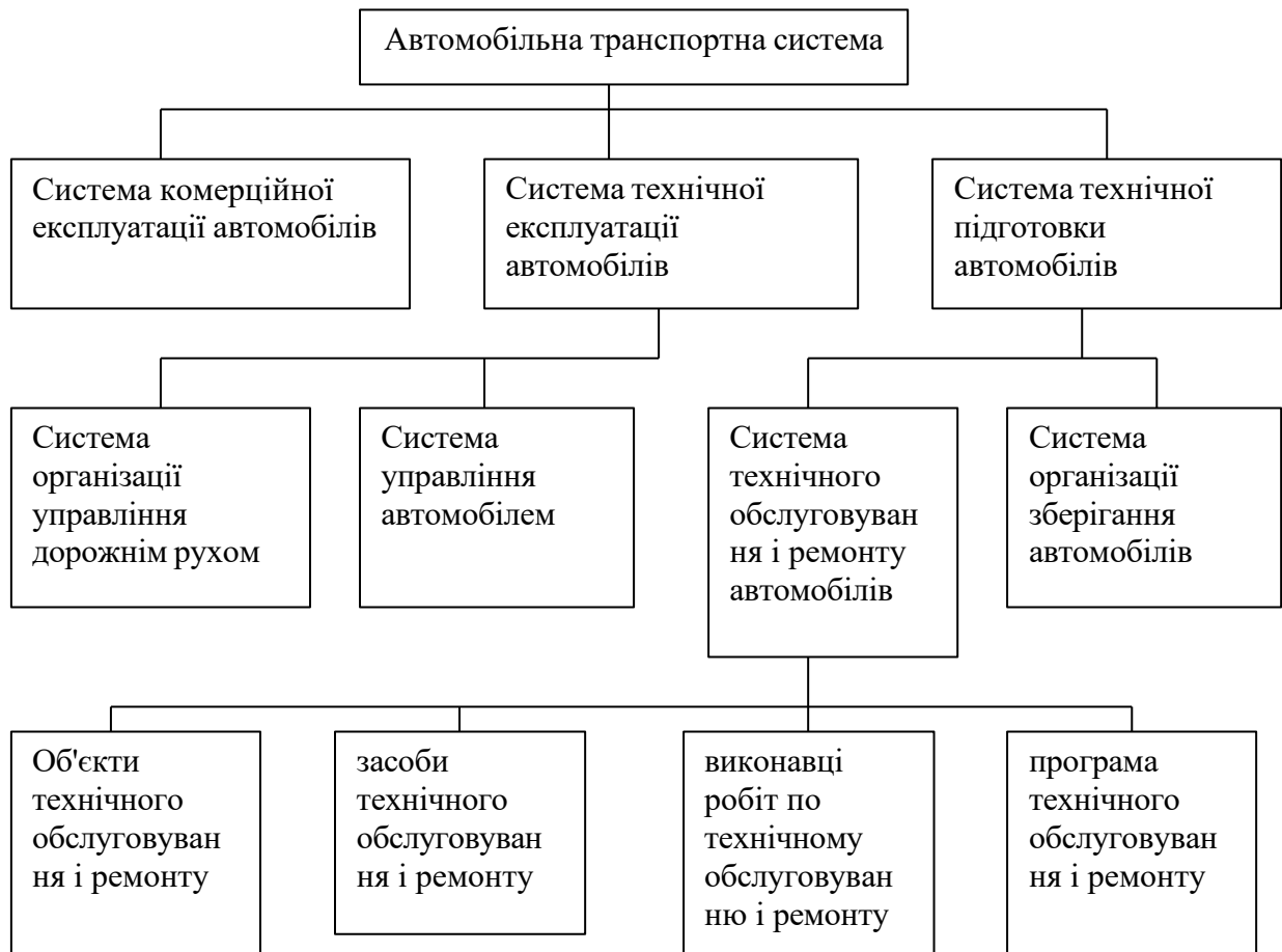
Рис. 1.1. Схема автомобільної транспортної системи
