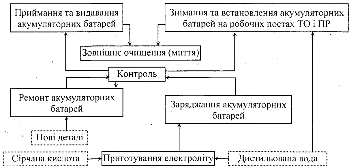
Рис. 3.22. Схема технологічного процесу відновлення працездатності акумуляторних батарей
